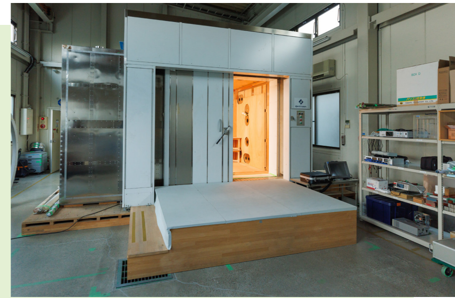
工場内に設置された研究開発用の磁気シールドルーム。大学の研究のために貸し出すこともある
